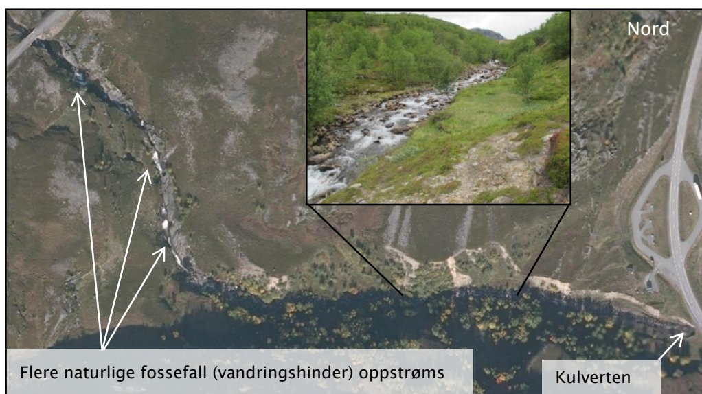
Fig. 12. Flyfoto over elveløp oppstrøms kulvert. Det innfelte bildet viser vandringsforholdene oppstrøms kulverten. Lenger opp i elva ble det registrert flere naturlige vandringshinder. Disse er vist med piler. Vurderingen av de naturlige vandringshindrene tilsa at det var ingen hensikt med utbedring av vandringshinderet ved kulverten (Illustrasjon: Øyvind Haugland).
