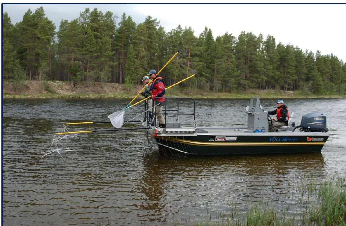
Bilde 5. Under elektrisk båtfiske i fire elver på Sørlandet høsten 2019 ble det benyttet en 18 fots aluminiumsbåt med en 200 hestekrefters utenbordsmotor med vannjet. Illustrasjonsbildet er fra en tilsvarende undersøkelse som ble gjennomført i Rena. Foto: Jon Museth, NINA.
