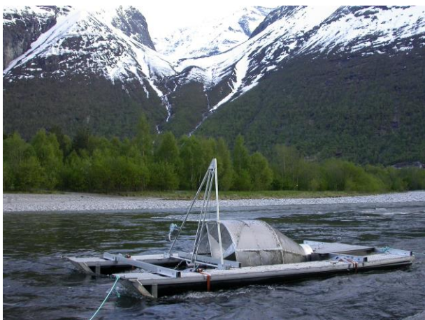
Smoltfangst ved bruk av smoltskrue
