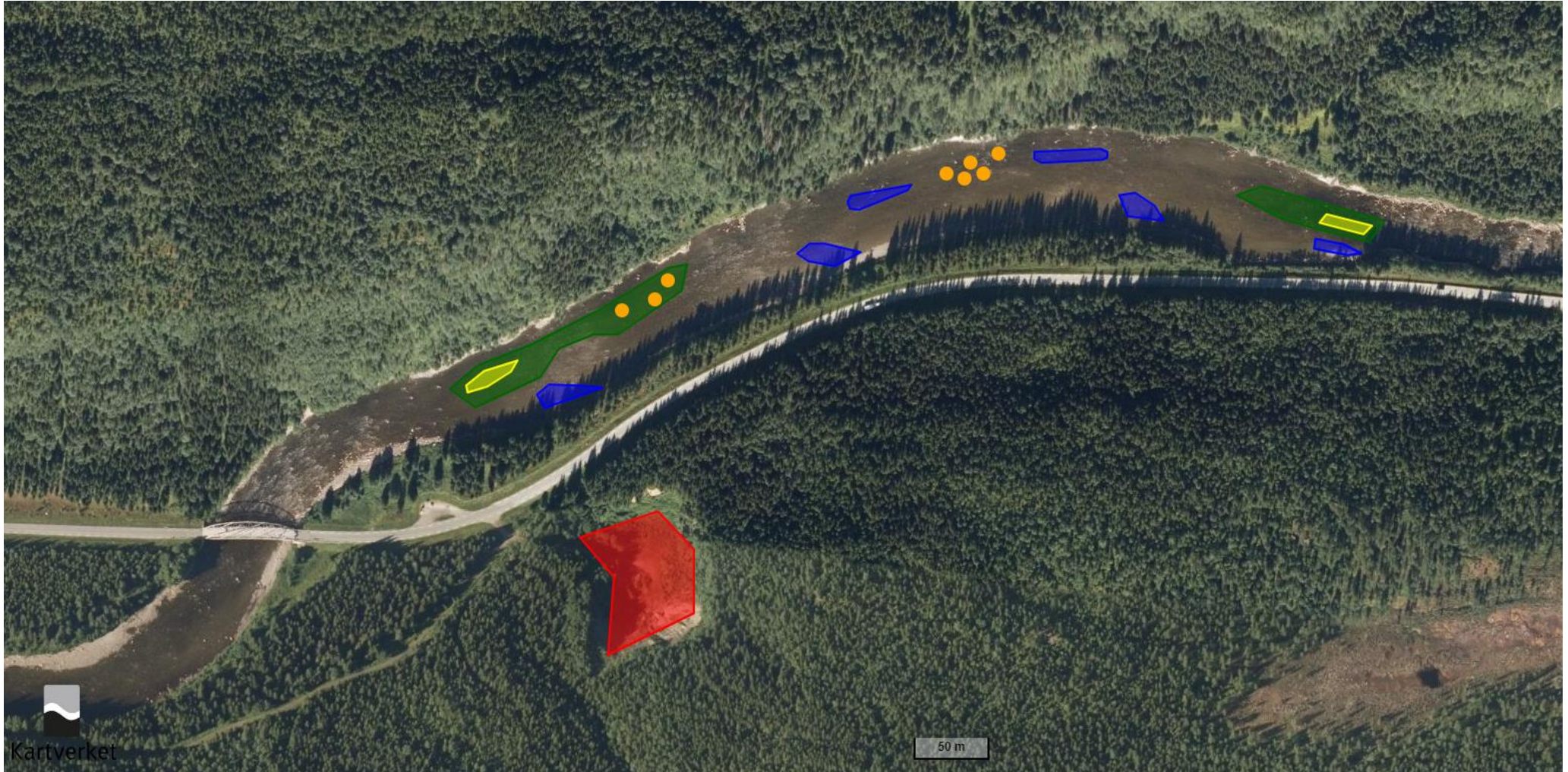
Figur 2. Rød markering er forslag på deponi og soldringområde. Blå markeringer er steinrygger som enten styr vannstrømmen i en gunstig retning, fungerer som skjul, eller begge deler. Grønn markering er dypål der det skal graves ut 0,5m med masse. Sand og småstein såldres vekk og større stein legg tilbake. Gul markering er ekstra dype områder i dypålen der det skal graves ut 1m med masse. Orange punker er stein blokk som legges ut på bunn og som skal fundere som skjul.
