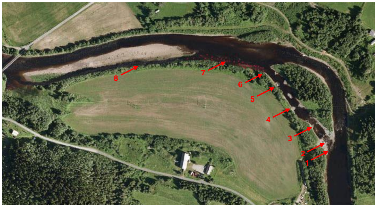
Figur 9. Et manipulert bilde som illustrerer hvordan området kan se ut etter tiltak. Røde prikker ved punkt 7 er utlagt stein.
