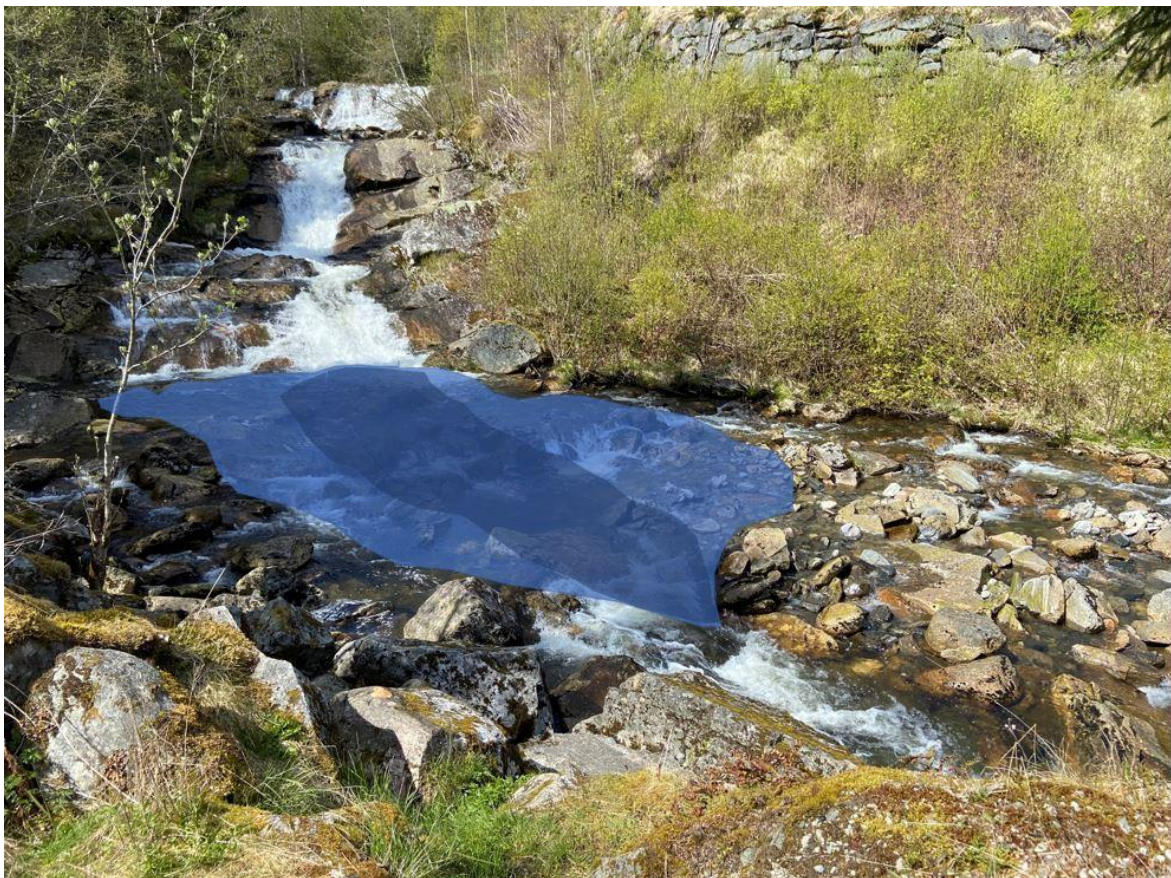
Figur 8. Skisse av hvor kulpen er tiltenkt. Den mørkere blåfargen indikerer dyprenne som bør gå mot dit vannstrømmen trekker under dagens forhold for å sikre best vandringsvei for fisk.
