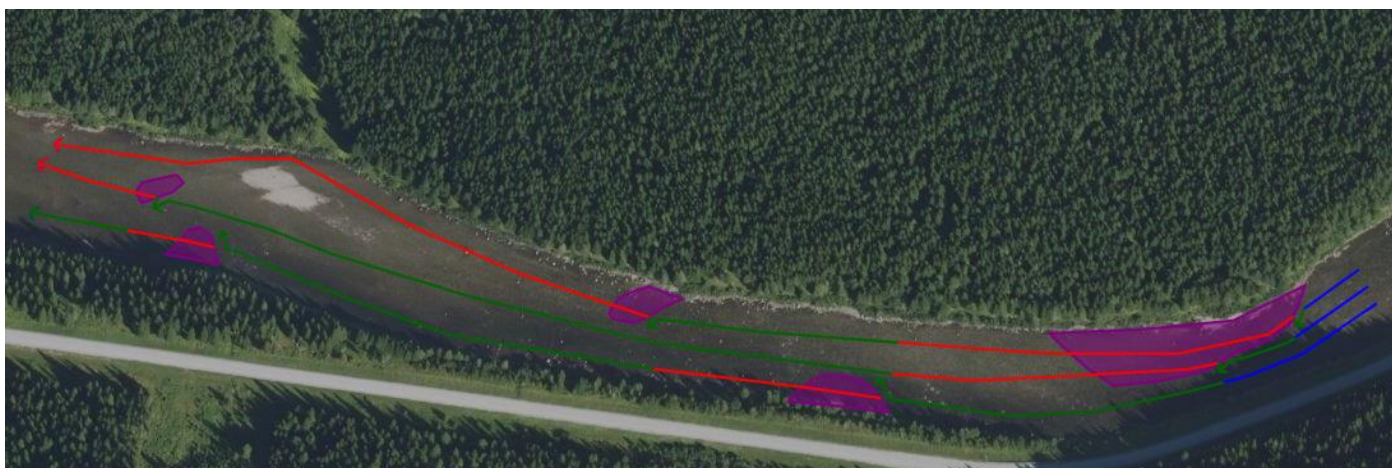
Figur 13. Teoretisk tegning av strømretning i elva etter tiltaket. Lilla områder er der vi lagt ut stein for at styre elva til å svinge mere.
