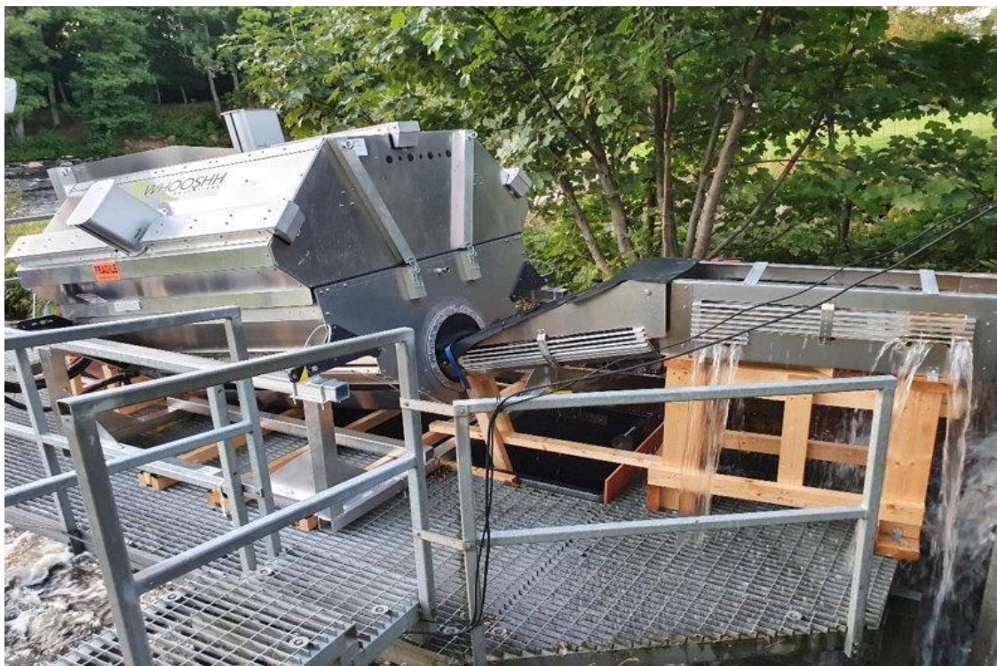
Bilde 2. Whooshh Innovations i USA har utviklet flere tekniske løsninger for automatisk identifisering og sortering av fisk. Illustrasjonsbildet er fra et system som har vært benyttet i Ätran i Sverige. Foto: Michael Messina, Whooshh Innovations.
